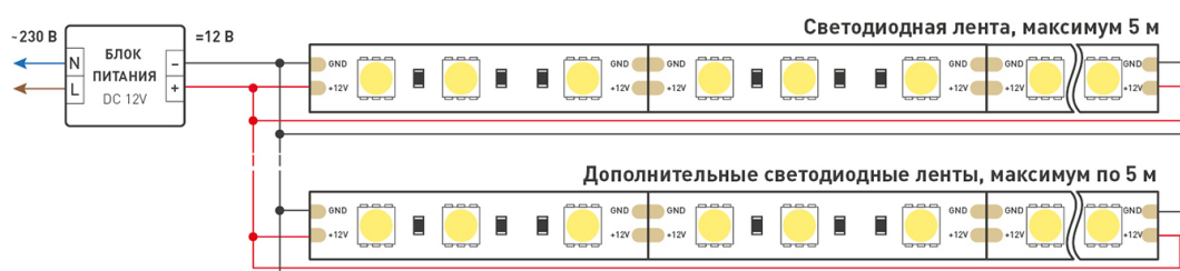
Схема 2. Подключение нескольких светодиодных лент с двух сторон. Рекомендуется использовать для обеспечения равномерного свечения ленты по всей длине.
